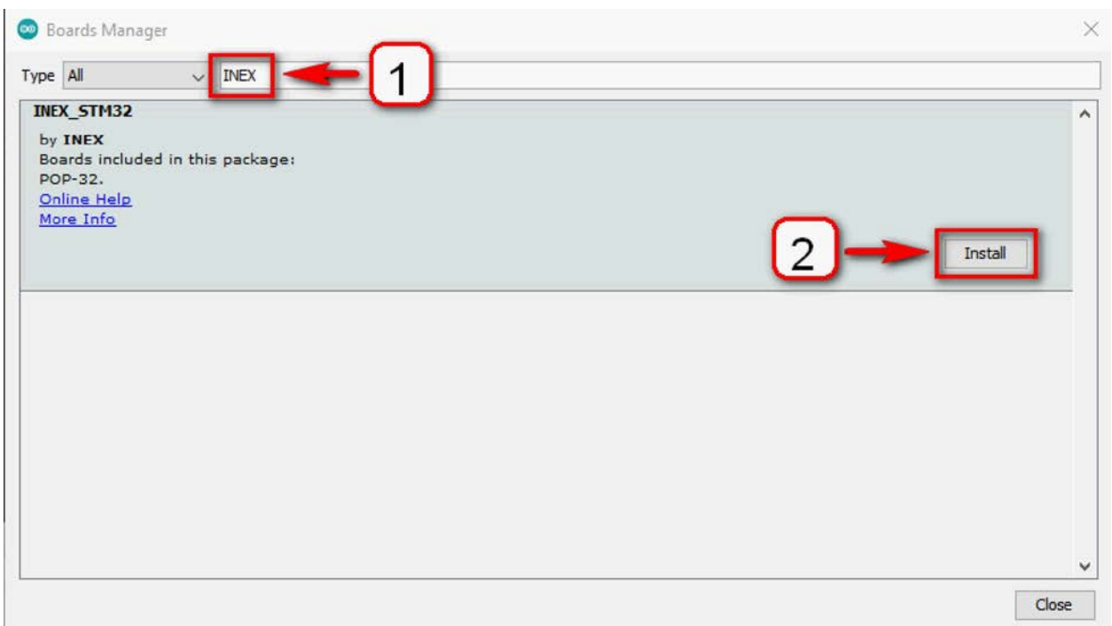
รูปที่ 2-12 แสดงหน้าต่าง Boards Manager สำหรับติดตั้งไลบรารีและข้อมูลทางฮาร์ดแวร์ของ INEX_STM32
